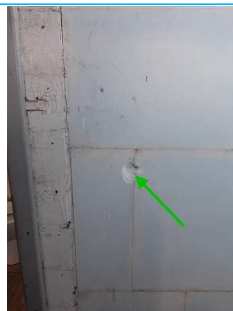
Matériaux : ZPSO-006 Prélèvement : P006 Description : Joint de carreaux de plâtre Localisation : Chauffage - Douches Résultat : Absence d'amiante
