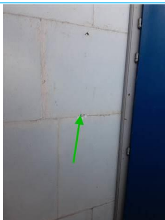
Matériaux : ZPSO-005 Prélèvement : P005 Description : Joint de carreaux de plâtre Localisation : Chauffage - Douches Résultat : Absence d'amiante
